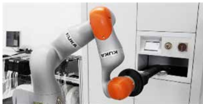
<LBR iiwa 지능형 협동 로봇, 사진 출처 : KUKA 홈페이지>
